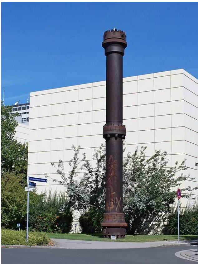
Reactor utilizado en 1921 para la producción de amoniaco, Karlsruhe Institute of Technology .
