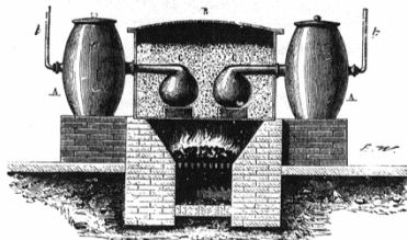
Fig. 19. — Sublimation de l'iode dans l'appareil des fabriques.
