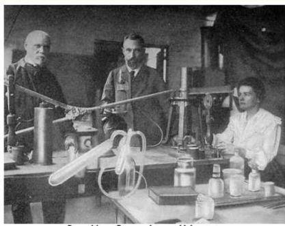
Pierre, Marie i Becquerel, junts al laboratori amb l'electròmetre de quars piezoelèctric fabricat per Pierre i el seu germà Jacques.
